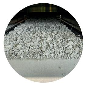
FIGURE 5 - THE DRIED METAL FRACTION FROM HALOSEP
